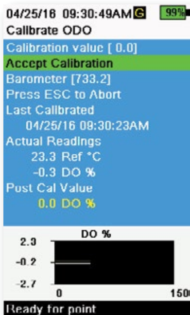
Kuva 10. ODO 0-pisteen kalibrointi
