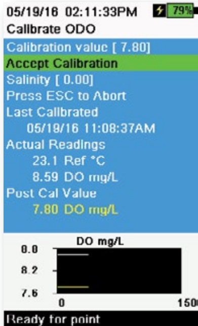
Kuva 9. ODO mg/l kalibrointi
